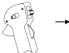
2. Залейте бензин в карбюратор медленным нажатием кнопки подкачки несколько раз до тех пор, пока бензин не поступит в карбюратор.
