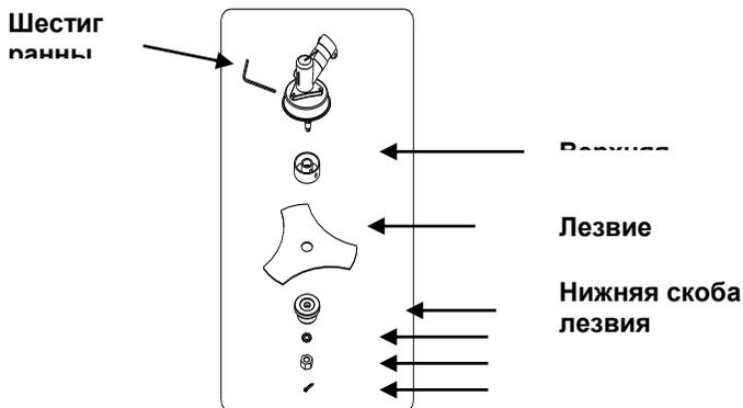
Выньте шплинт, открутите гайку по часовой стрелке (в правую сторону) и снимите нижнюю скобу лезвия.
