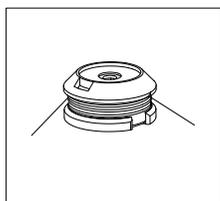
Прикрутите нейлоновую насадку против часовой стрелки (в левую сторону) по резьбе штока в конце приводной части. Зафиксируйте шток на месте, вставив отвёртку или ключ-шестигранник в отверстие в верхнем зажиме насадки и крепко затянув винт.
